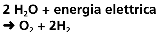
Fig. 5 Reazione complessiva del processo di elettrolisi dell'acqua. Due molecole di acqua sottoposte ad un flusso di corrente elettrica si scindono a dare una molecola di ossigeno e due molecole di idrogeno.
